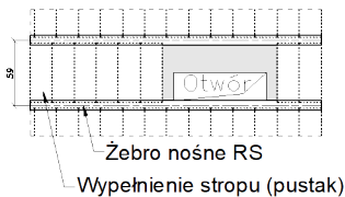
Detal dozbrojeń przy przepuszczeniu
