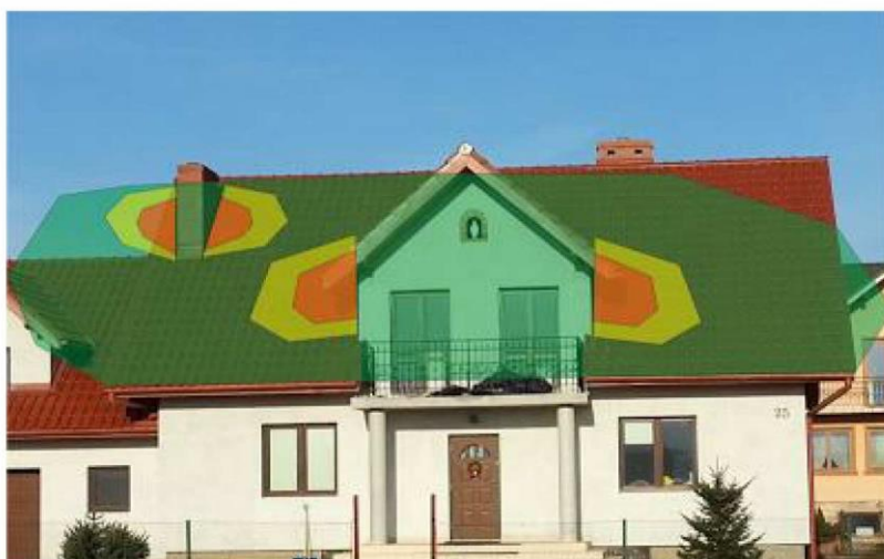
Rys. 1 Strefy zacinienia na dachu skierowanym na południe
