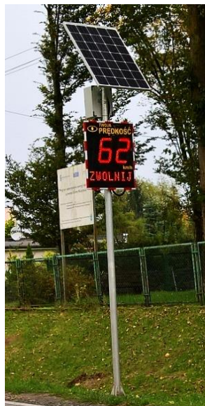
Rysunek 19. Przykładowa realizacja ustawienia wyświetlacza z rzeczywistym pomiarem prędkości z zasilaniem solarnym (źródło: 3D Systemy Informacyjne)
