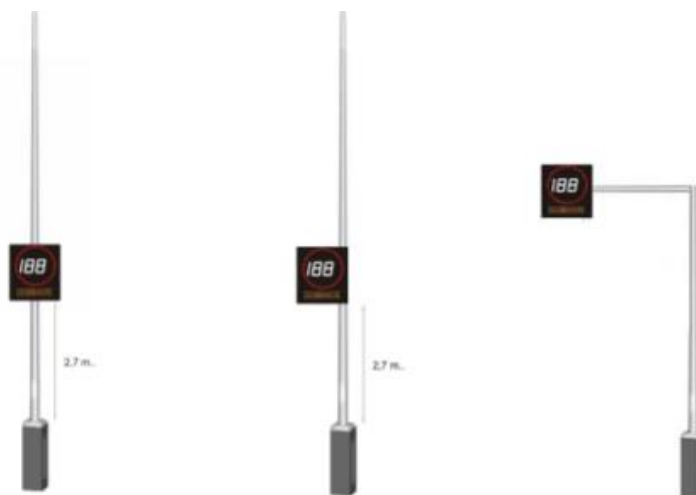
Rysunek 24. Sposób montażu wyświetlacza prędkości (źródło: 3D Systemy Informacyjne).
